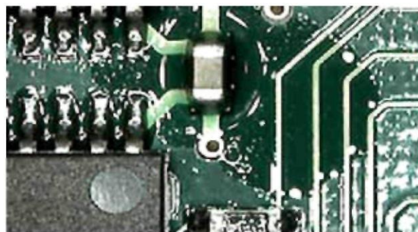
Смачиваемость масла на печатной плате без защитного покрытия
