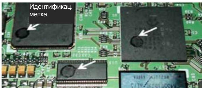
Рис. 1. Примеры маркировки темных компонентов каплями покрытия Novoc™ 1700 для идентификации узлов с уже нанесенным покрытием
